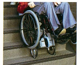
後輪を抜いてホルダーに付けたまま昇降できます。
